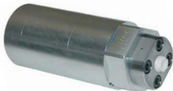
Le modèle MP-L-2000 est issu de la série MP-L. Il est conçu pour un équipement destiné à pulvériser du béton (démolition), pour lequel l'alternance basse pression et pression élevée est nécessaire. Le MP-L-2000 est capable de délivrer une pression jusqu'à 2500 bar.
