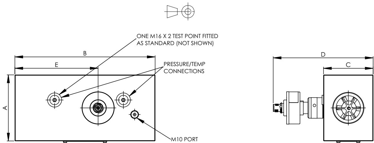
CT 15 hat einen Anschluss für Druck- bzw. Temperatursensoren
