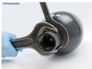
小心地将出液口组件推入容器中并固定位置，以便取出密封圈和抗挤压环。
