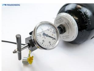
使用测试和填充装置将氮气缓慢注入气囊内，使得气囊在膨胀时可逐渐展开并平滑地抵靠容器的内表面。充气压力不应超过1巴，气囊只可接触出液口壳体组件的提升阀。
