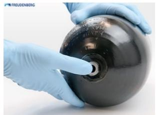
小心地将自由气阀杆推入容器内，直至气囊从容器底部脱离。
