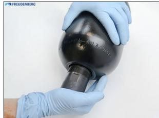
Den ggf. vorhanden Kammerring, den Dicht- und Stützring vom Ventilkörper lösen und aus dem Speicher entnehmen.
