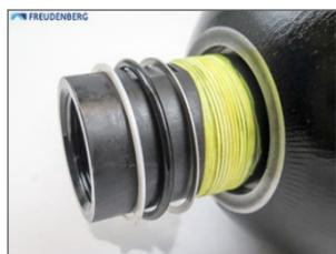
Glisser la bague d'écartement sur le boîtier de la vanne de liquide et positionner son épaulement de centrage dans l'espace séparant le réservoir et le boîtier.
