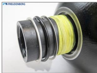
Desplazar el anillo distanciador sobre la carcasa de la válvula de fluido y posicionar su collar de centrado en el espacio entre el depósito y la carcasa.
