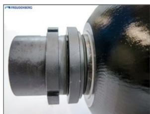
Visser l'écrou rainuré sur le filetage du boîtier de vanne et le visser à la main avec la bague d'écartement. En se référant au dessin ou aux instructions du paragraphe 4.1. et en appliquant le couple requis tout en bloquant le boîtier de la vanne de liquide, serrer ensuite l'écrou rainuré à l'aide d'une clé à douille et à ergot.
