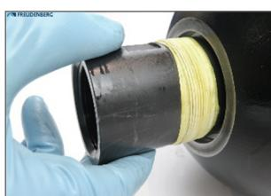
Mit Hilfe der Prüf- und Füllvorrichtung die Blase so langsam befüllen, dass diese sich während der Expansion allmählich entfalten und gleichmäßig an den Behälterinnenkontur anlegen kann. Der Gasfülldruck sollte dazu 1 bar nicht überschreiten und die Blase nicht das Tellerventil des Flüssigkeitsanschlusses berühren.
