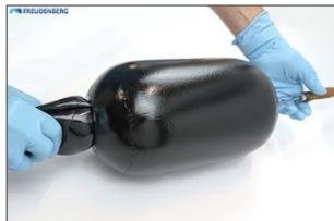
Gasventilträger mit Hilfe der Gewindestange durch die gasseitige Durchgangsbohrung führen. Das Typenschild und anschließend die Haltemutter über die Gewindestange bis zur Behälteranlagefläche führen. Die Haltemutter locker auf den Gasventilträger schrauben und noch nicht verspannen. Die Gewindestange entfernen.
