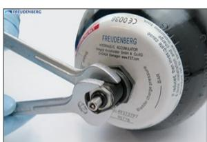
Guider le boîtier du raccord de liquide, la collerette d'appui étant orientée vers l'extrémité gaz, à travers le trou de positionnement côté huile et le placer à l'intérieur du réservoir. Si nécessaire, démonter préalablement la vis de purge latérale.
