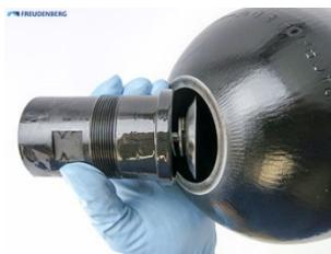
将气囊从蓄能器中取出。在重复使用气囊的情况下，必须防止提取过程造成表面损坏。
