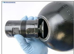
Retirar la vejiga a través del orificio del depósito. Si se ha de volver a utilizar la vejiga, evitar dañar las superficies durante la extracción.
