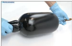
En utilisant la tige filetée, guider le support de la vanne de gaz à travers le trou de passage du côté gaz. Guider la plaque signalétique, puis l'écrou de retenue sur la tige filetée jusqu'à la surface de contact du réservoir. Visser l'écrou de retenue sur le support de la vanne de gaz et ne pas encore le serrer. Retirer la tige filetée.
