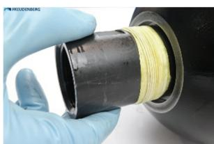
引导出液口壳体的螺纹端穿过定位孔并将其放在固定位置上，也就是将抗挤压环定心槽的反面放在容器内。
