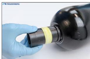
Volver a irrigar con lubricante el orificio de alojamiento en el lado de aceite. Doblar ligeramente el anillo de centrado dividido e introducir en el interior del depósito a través del orificio de alojamiento, a ser posible sin fricciones.
