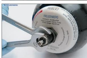
Das Gehäuse des Flüssigkeitsanschlusses mit zum Gasende orientierten Anlagebund durch die ölseitige Aufnahmebohrung führen und im Behälterinnen ablegen. Ggf. seitliche Ablassschraube zuvor demontieren.
