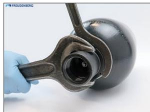
Pousser doucement la vanne de liquide vers l'intérieur du réservoir et la positionner de manière à pouvoir sentir la bague d'étanchéité et la bague de centrage fendue.
