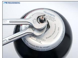
Lösen und Entfernen der Haltemutter mit gekontrten Gasventilträger (T2+T3).
