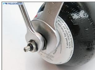
Das Flüssigkeitsventil und den geteilten Ring erneut zentrieren, dabei eine umlaufende Anlage im Gehäusesitz sowie eine gleichbleibende Spalthöhe zwischen Gehäusemantel und Aufnahmebohrung herstellen. Das Gehäuse in Position halten. Die Blase weiter befüllen bis diese auf das Tellerventil einen ausreichend großen Druck ausübt um ein Verschieben des Anschlussgehäuses während der folgenden Montageschritte zu verhindern. Der Fülldruck sollte dazu 2 bar nicht überschreiten.
