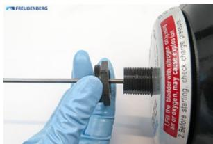
将预装配的阀芯和密封件拧入气阀主体中。将阀体拧紧至 $14^{+2}$  Nm，同时用扳手锁定气阀杆。
