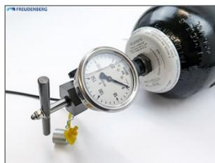
Gasventilträger in der Durchgangsbohrung zentrieren, an den Schlüsselflächen kontern und die Haltemutter mit  $50^{+5}$  Nm verspannen.
