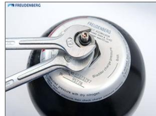
Soltar y retirar la tuerca de sujeción con portaválvulas de gas fijados por contratuerca (T2+T3).
