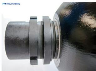
将开槽螺母拧至出液口壳体的螺纹上，并用间隔环手动拧紧。然后使用钩形转矩扳手反向转动出液口壳体以拧紧开槽螺母，并且根据图纸或规格Cf. 4.1施加推荐的转矩。
