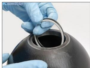
Retirer la bague de centrage fendue du corps de la vanne, la plier avec précaution et uniquement dans la mesure du nécessaire, puis la sortir par l'ouverture du réservoir.
