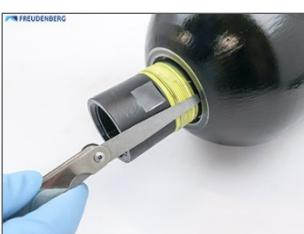
Guia cuidadosamente la cámara anular (para acumuladores a partir de 10 l), a continuación la junta tórica y, finalmente, el anillo de apoyo con un alzador de junta tórica (o similar) sobre la rosca de la válvula de fluido y montarlos en el espacio entre el depósito y la superficie del revestimiento del alojamiento de la carcasa. Desplazar los anillos axialmente hasta el anillo de centrado sin torcer ni aplastar la junta tórica.
