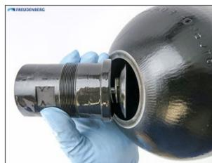
Retirer la vessie par l'ouverture du réservoir. En cas de réutilisation de la vessie, éviter d'endommager la surface lors de l'extraction.
