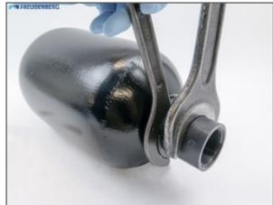
Si nécessaire, remplir la vessie de façon à atteindre la pression de remplissage du gaz requise. Pour des raisons de sécurité, Freudenberg recommande de ne pas effectuer de remplissage avant que l'accumulateur ne soit installé et sécurisé.
