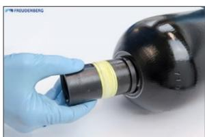
Lubrifier de nouveau le trou de positionnement côté huile. Replier légèrement la bague de centrage fendue et l'introduire à l'intérieur du réservoir par le trou de positionnement en évitant, autant que possible, tout frottement.
