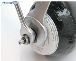
在油端，再次使出液口及其抗挤压环居中，与容器底座成均匀接触，并在出液口壳体和容器的定位孔之间形成恒定的环状间隙高度。将外壳放置在固定位置上。继续填充气囊，直至其可对提升阀产生足够的压力，以防止出液口壳体组件在后续的组装步骤中移动。填充压力不得超过3巴。
