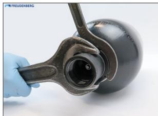
Soltar del cuerpo de la válvula la cámara anular posiblemente existente, el anillo de junta así como el de apoyo y retirarlos del acumulador.
