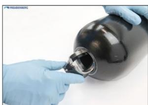
Pousser la bague de centrage fendue à l'intérieur du réservoir en la glissant sur le boîtier, la surface de contact étant orientée vers la collerette du boîtier de raccordement.
