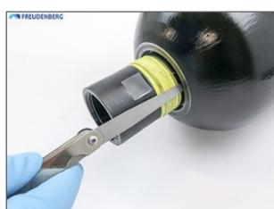
Den Distanzring über das Flüssigkeitsventilgehäuse schieben und seine Zentrierschulter im Spalt zwischen Behälter und Gehäuse positionieren.
