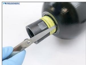
Guider prudemment la chambre-bague (pour accumulateurs à partir de 10 l), puis le joint torique et enfin la bague d'appui sur le filetage de la vanne de liquide avec un élévateur à joint torique (ou un outil similaire) et les monter dans l'espace séparant le réservoir et la surface de l'enveloppe de positionnement du boîtier. Glisser les bagues axialement jusqu'à la bague de centrage en veillant à ce que le joint torique ne soit ni excessivement serré, ni torsadé.
