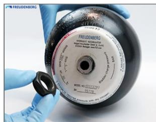
Pousser avec précaution le corps de la vanne de gaz maintenant libre vers l'intérieur du réservoir jusqu'à ce que la vessie se détache du fond du réservoir.
