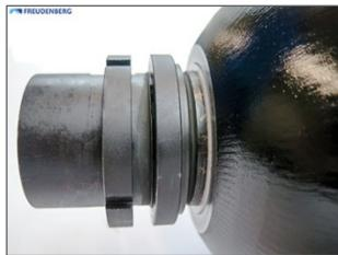
Enroscar la tuerca ranurada en la rosca de la carcasa de la válvula y atornillar a mano al anillo distanciador. A continuación apretar con una llave de gancho la tuerca ranurada y la carcasa de la válvula de fluido fijada por contratuerca conforme al par recomendado según el dibujo y la especificación del capítulo 4.1.
