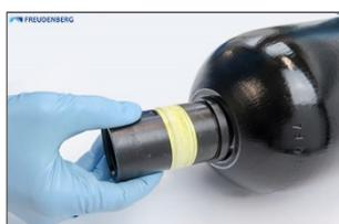
Die ölseitige Aufnahmebohrung erneut mit Schmierstoff beneten. Den geteilten Zentrierring leicht zusammenfalten und möglichst Reibungsfrei durch die Aufnahmebohrung ins Behälterinnere einführen.
