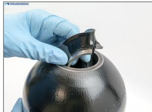
Das Flüssigkeitsventil durch die Behälteröffnung entnehmen.
