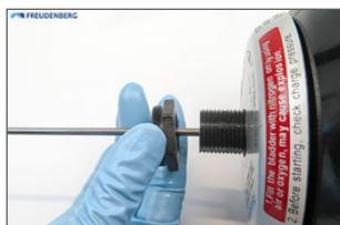
Einschrauben des Gasventilkörpers mit vormontiertem Ventileinsatz und zugehörigen Dichtungen. Ventilkörper mit 14<sup>±</sup>2 Nm bei gleichzeitig an den Schlüsselflächen gekontrierten Gasventilträger verspannen.
