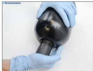
Desserrer la chambre-bague éventuelle, la bague d'étanchéité et la bague de support du corps de vanne et les retirer de l'accumulateur.
