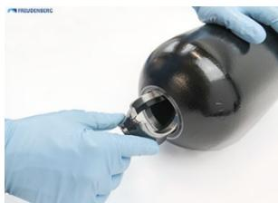
将抗挤压环放入容器内部的出液口壳体上，使其接触表面与壳体的轴环对齐。
