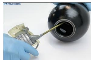
Comprimer légèrement la vessie à la tête, l'insérer à travers l'ouverture de l'accumulateur côté fluide et la pousser progressivement à l'intérieur du réservoir. S'assurer que la vessie ne se plie pas et n'est pas torsadée.
