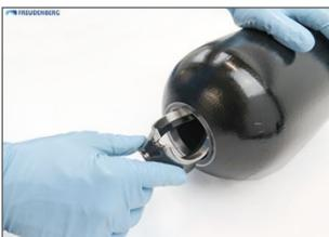
Dentro del depósito, empujar hasta la carcasa el anillo de centrado dividido con la superficie de contacto orientada al collarín de la carcasa de conexión.
