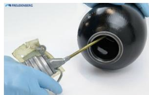
轻轻挤压气囊的头部，穿过液端的开口，逐步推入容器内。确保气囊不会扭曲或弯曲。
