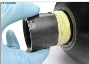
Centrar el portaválvula de gas en el orificio de paso, fijar por contratuerca en las superficies de las llaves y apretar la tuerca de sujeción a  $50^{\circ}$ .
