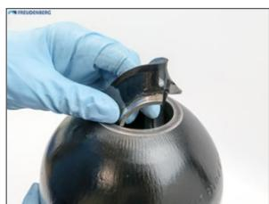
Retirer la vanne de liquide par l'ouverture du réservoir.
