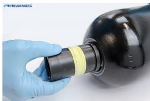
再次润滑油侧的定位孔。轻轻折叠抗挤压环，并尽可能小心地将其通过定位孔插入容器内部。
