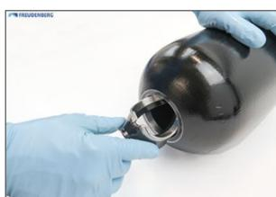
Im Behälter den geteilten Zentrierring mit zum Bund des Anschlussgehäuses orientierter Anlagefläche auf das Gehäuse schieben.
