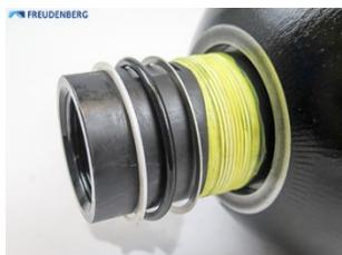
将间隔环滑入出液口壳体上，并将其定心肩部放置在壳体和容器之间的间隙中。
