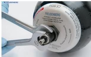
将出液口壳体组件插入并引导其穿过油侧的容器孔，使轴环朝向气端并放置在容器内。如果可行的话，先拆除侧面的排放塞。
