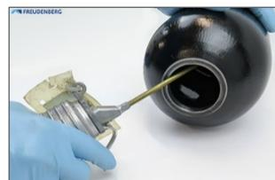
Blase am Kopf leicht zusammendrücken, durch die Speicheröffnung der Fluidseite einführen und schrittweise in das Behälterinnere schieben. Dabei darauf achten, dass die Blase nicht verdrillt oder knickt.
