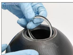
Extraer cuidadosamente el anillo de centrado dividido del cuerpo de la válvula solamente en la medida necesaria para poderlo doblar y extraerlo a través del orificio del depósito.
