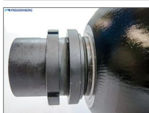
Die Nutmutter auf das Gewinde des Ventilgehäuses schrauben und handfest mit dem Distanzring verschrauben. Anschließend die Nutmutter mittels einem Hakensteckschlüssel und gekonterten Flüssigkeitsventilgehäuse drehmomentgesteuert nach Zeichnung, bzw. Vorgabe Kapitel. 4.1 verspannen.
