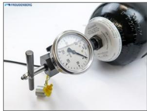
Centrer le support de la vanne de gaz dans le trou de passage, le bloquer avec les faces de la clé et serrer l'écrou de retenue en appliquant un moment de 50+5 Nm.
