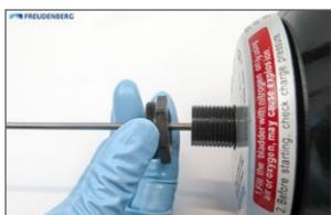
Visser le corps de la vanne de gaz avec l'insert de vanne prémonté et les joints correspondants. Serrer le corps de vanne avec un moment de  $14 \cdot 2$  Nm en bloquant en même temps le support de la vanne de gaz avec les faces de la clé.
