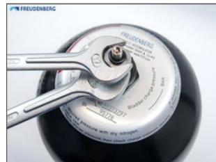
Desserrer et enlever l'écrou de retenue en bloquant le support de la vanne de gaz (2+T3).
